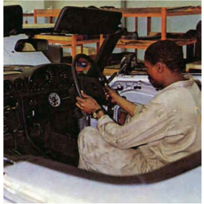
4. Armaturenbrett bereits eingebaut, Lenkrad wird gerade montiert
