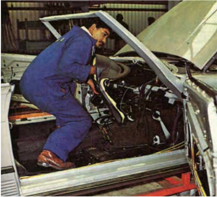
3. Ein 450 SL zurück aus der Lackiererei – Einbau des Armaturenbretts
