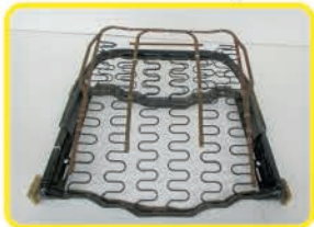
Neuaufbau 107er Sitzfederkern
