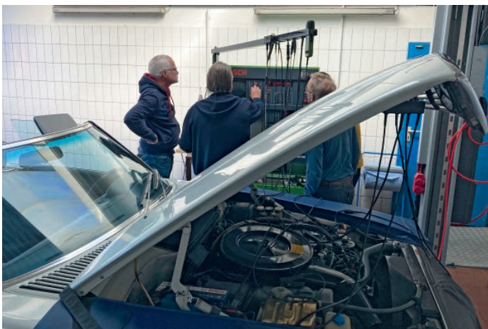
Überprüfung der Zündanlage am Werkstattstester
