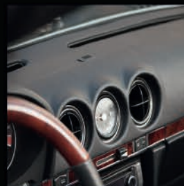
Armaturenbrettrestaurierung Vinyl in korrekter Narbung
