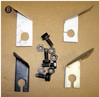
Wie immer, zuerst Papierschablone, dann Halter nachgefertigt
