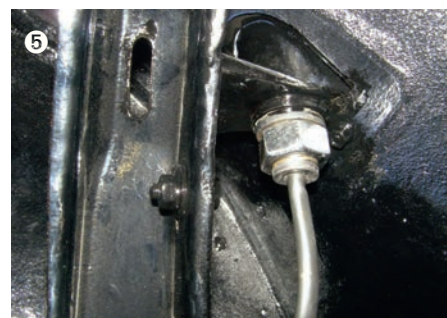
Hauptlast am Kotflügelhalter und Abstützung
