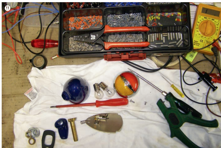
Umbau der originalen Zweikammer-Eierleuchte auf drei Funktionen
