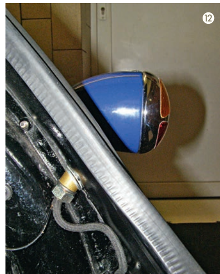
Kabelbaum ohne Stückelung direkt im Sockel eingeführt
