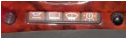
Beim Start-Funktionstest sollen alle gleich hell sein. Störanzeigen sind heller leuchtend.
