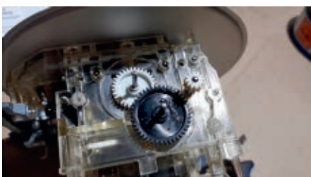
Das Getriebe noch ohne die neuen zwei Zahnräder
