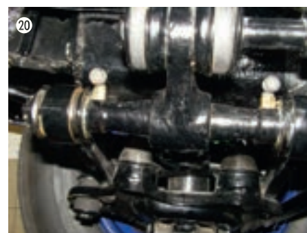
Nach dem Schmiernippelumbau mittels Schmiernippel
