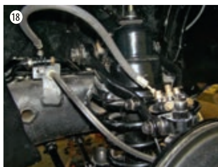
Dosiereingestellte Schmierstellenverteiler, deren Zuleitungen usw. bleibt alles eingebaut
