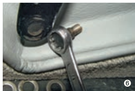
Montage natürlich nur mit Verbus, Kamax, o.ä. Originalschrauben mit 14er Kopf
