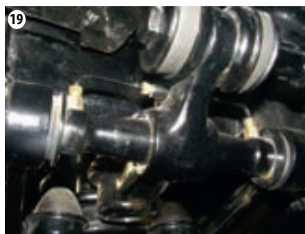
Vor dem Schmiernippelumbau mittels Verteile
