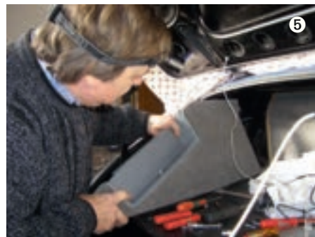
Einpassen der fertigen Seitenverkleidungen
