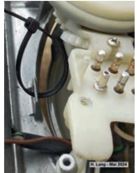
Mit einem Kabelbinder durch die Bohrung der Lasche das Entstörpaket befestigen.
