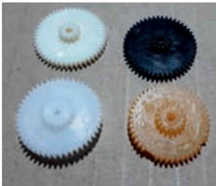
Links die neuen Zahnräder, rechts die ausgebauten defekten Zahnräder.
