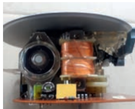
Die angebaute Platine mit den Elektronikbauteilen unterhalb des Schrittmotors des Wegstreckenzählers.
