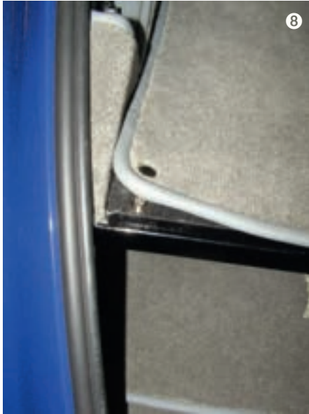
Die Veloursteppiche sind nicht verklebt, sondern nur mit Druckknöpfen fixiert
