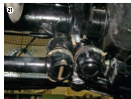
Das Abschmierfett quillt aus den Schmierstellen, ohne abzutropfen
