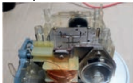
Tacho mit abgelöteter Platine
