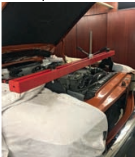
Traverse zum Auffangen des Motors ist bereit
