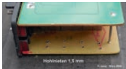
Hohlknoten 1,5 mm einsetzen und verstemmen
