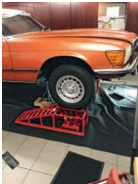
Erste Vorbereitung zum Ausbau der Vorderachse
