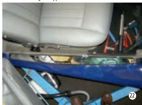
Die Schwellerleisten übernehmen gleichzeitig auch die Einfassung von Teppich und Türkedern
