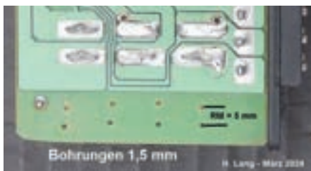
Im Rastermaß der Elkos Bohrungen 1,5 mm
