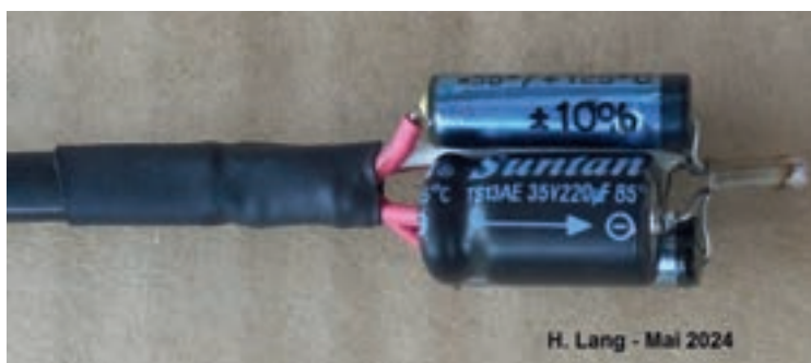
Mit Elkos den Strom glätten; mit Wickelkondensatoren die hochfrequenten Schaltspitzen dämpfen.
