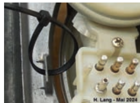
Einen Kabelbinder durch die Bohrung der Lasche stecken.
