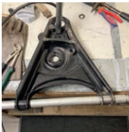
Querlenker wird instandgesetzt
