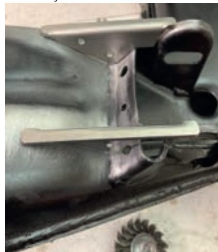
Achsverstärkungen bereit zum Einschweißen
