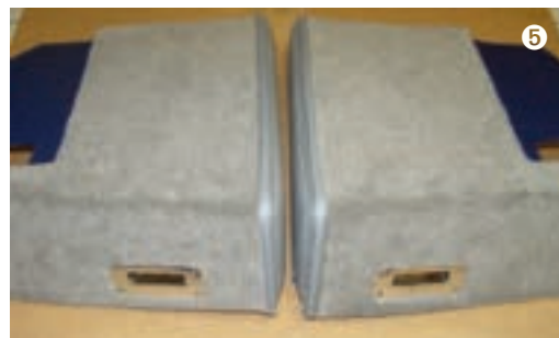
die Seitenteile stehen auch später exakt, aber lose im Fond, um so das Schälpern und Quietschen sicher zu verhindern
