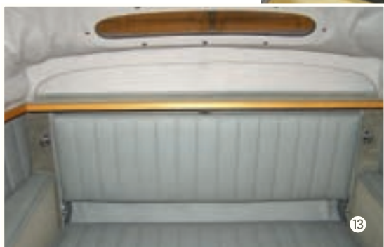
die Falten des Verdeckhimmels kommen auf dem Foto wegen des nur halb geöffneten Verdecks während den Montagearbeiten zustande
