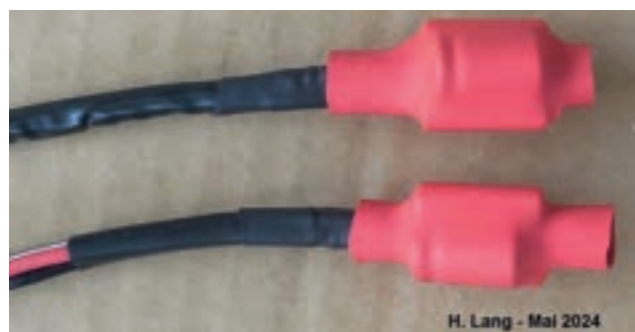
Jeweils vier Kondensatoren im Schrumpfschlauch verpackt.
