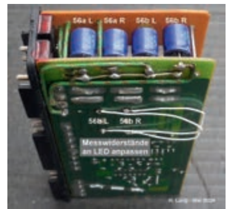
Elkos 220 µF 35 V einsetzen und verdrahten.
