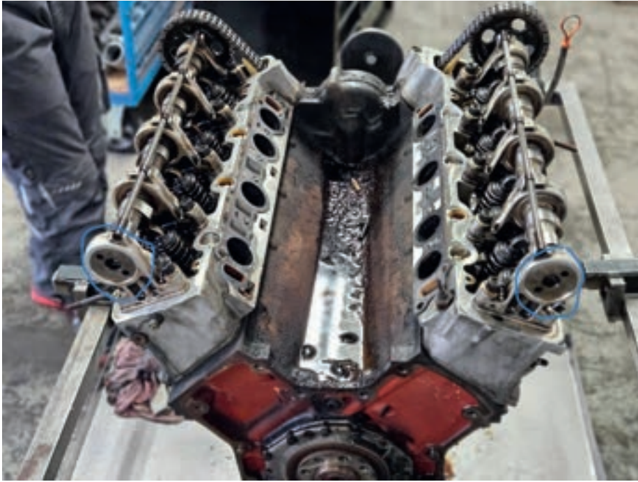
AMG Nockenwellen am teilzerlegten Motor
