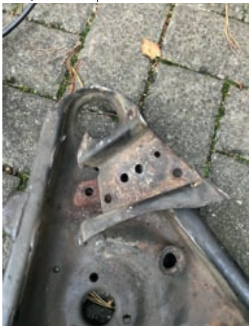
Unterer Querlenker vor der Reparatur
