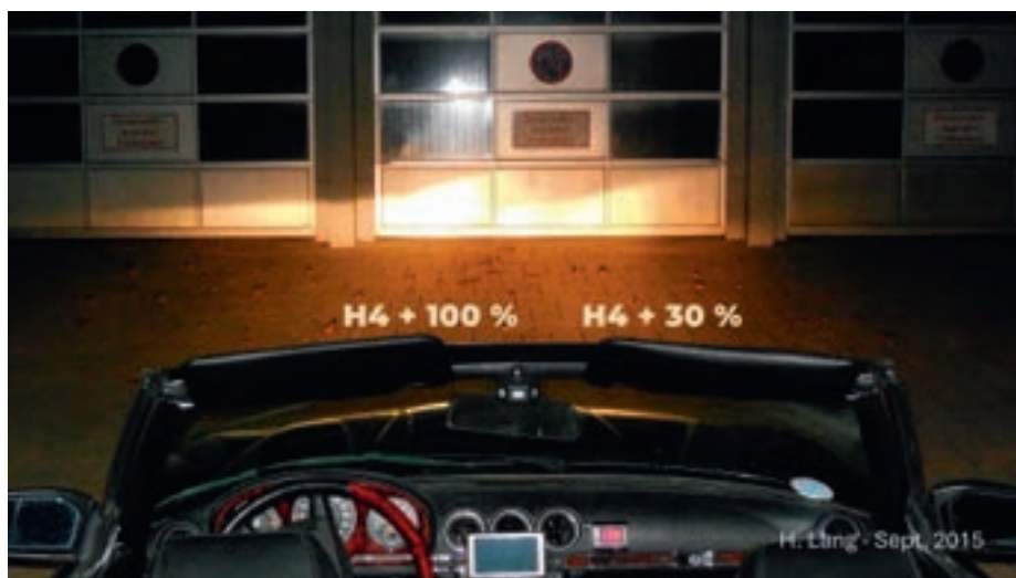
Helligkeitsvergleich mit der H4 + 30 % bei der Umstellung auf H4 + 100 % im Jahr 2015.
