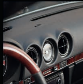
Armaturenbrettrestaurierung Vinyl in korrekter Narbung
