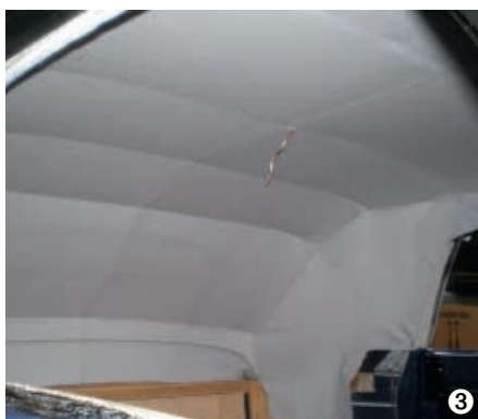
Zuleitung durch die Rosshaarsteppfüllung
