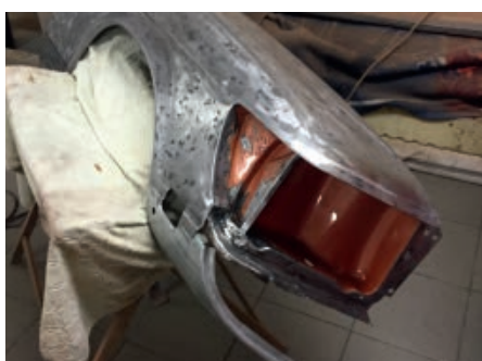
Kotflügel fertig zur Lackierung
