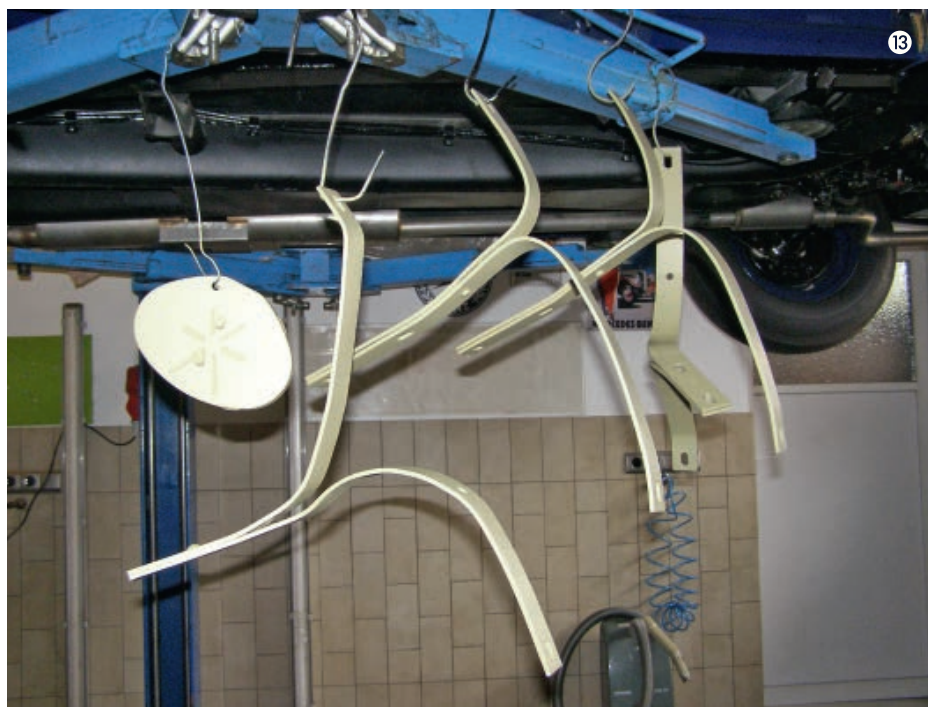
Aufarbeitung der Stoßstangenhalter aus Federstahl
