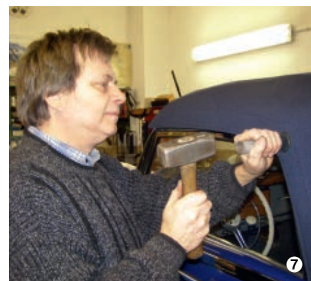
Aufpressen der Gummihülsen auf die Exzenter-Lagerbolzen
