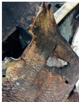
schadhafter Teil Kotflügel unten
