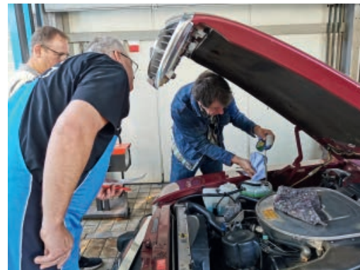
Messungen an der Kühlflüssigkeit
