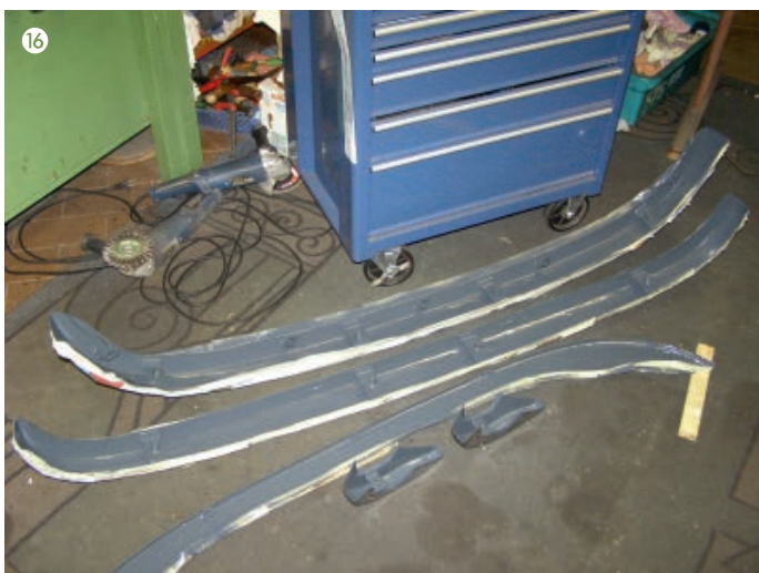
Innenlackierung aller verchromten Stahlteile in hellgrau RAL 7030
