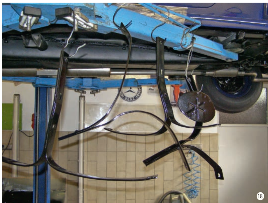
Endlackierung mit 2K Chassislack schwarz RAL 9005
