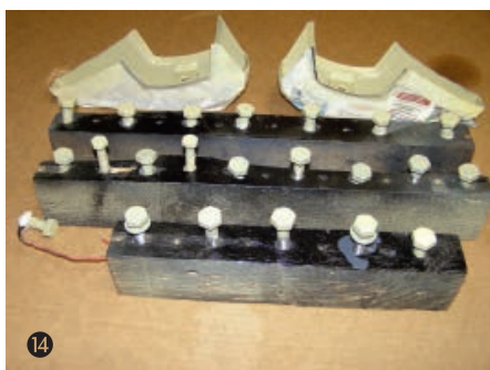
Grundierung mit Zinkphosphat aller steinschlaggefährdeten Teile
