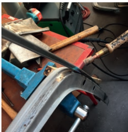
Unterträger Stoßfänger wird instandgesetzt
