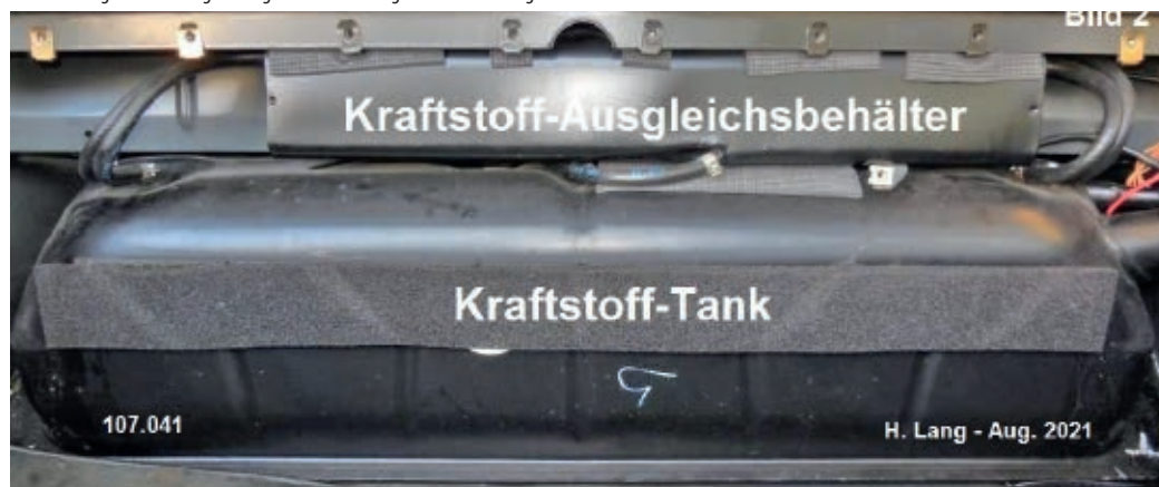
Die Belüftung mit Druckbegrenzung ist oben am Ausgleichsbehälter angeschlossen.
