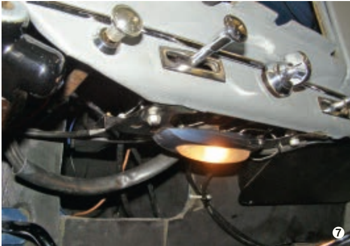
Fußraumbeleuchtung geschaltet über die beiden Türschalter in der B-Säule.
