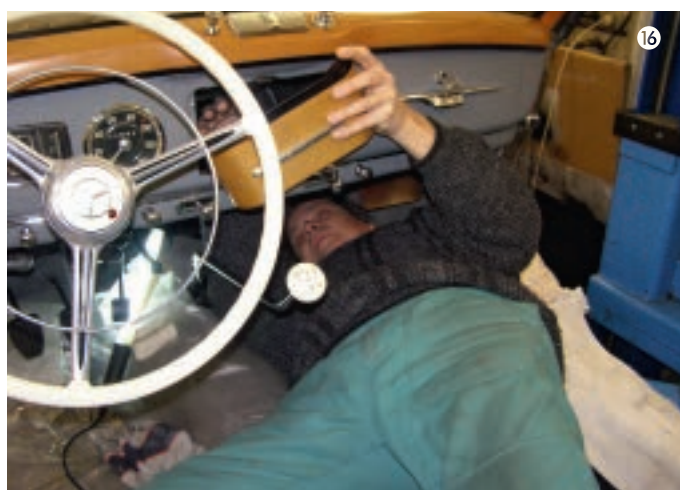
Anstatt ein Original-Beckeröhrenradio montierte ich eine äußerst rare Original-Radioblende aus Holz.
