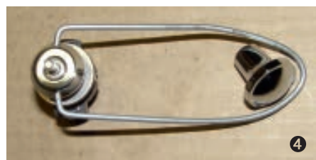
Anschrauben nur mit selbst angefertigtem „Spezialschlüssel“
