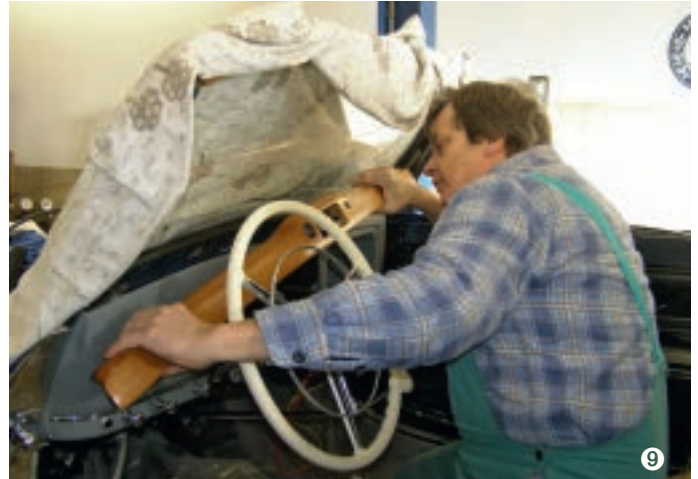
Anprobieren der oberen Zierholzabdeckung mit seinen Defroster-Aussparungen.
