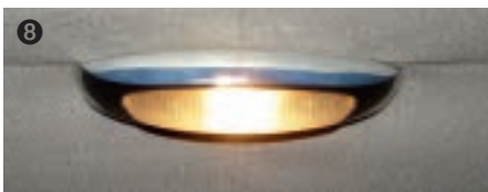
Deckenleuchte im Cabriooverdeck, geschaltet über Zugschalter im Cockpit.
