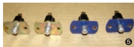
Zwei der vier Endschalter bekamen eine Lackierung in Wagenfarbe Indigoblau..
