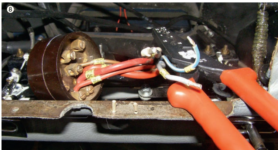
Jede freie Flexader bekommt eine passende Adernendhülse aufgestülpt und gecrimpt
