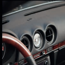
Armaturenbrettrestaurierung Vinyl in korrekter Narbung
