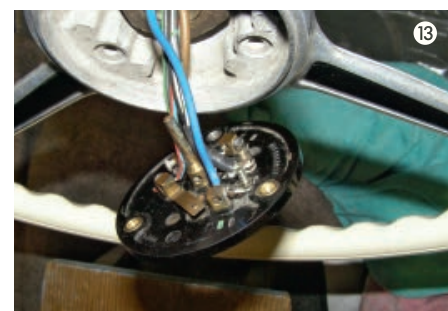
Kabelbaumende aus dem hohlen Lenkstock endend, für Blinker-/Winkerbetätigung mit Lenkrad-Hupenring + Kontrollleuchte
