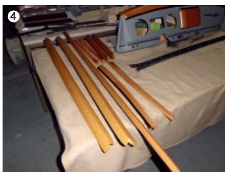
Sämtliche Holzzierleisten für den finalen Einbau vorbereitet
