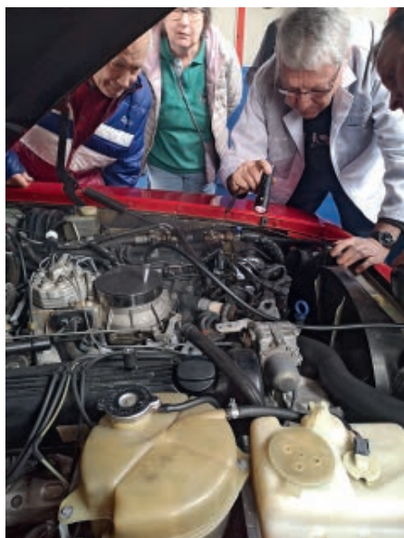
Nebelprüfung mit dem Adapter
