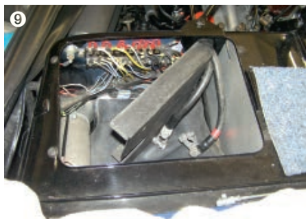
Das originale Schottbrettchen schützt vor gefährlichen Kurzschlüssen an Leitungsanschlüssen vor der Absicherung
