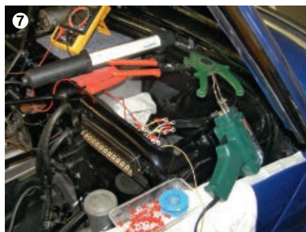
Ringösen nicht nur gequetscht, sondern zusätzlich verlötet. Das hält eine halbe Ewigkeit
