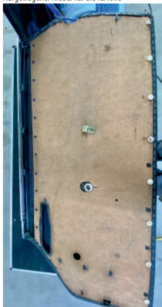
Aufgetragener Kleber für die Türfolie
