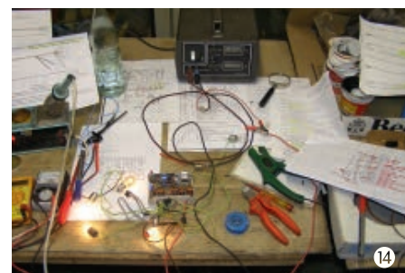
Versuchsaufbau zur Steuerung der gesamten Blinker-/Winkerfunktion mit Warnblinkschaltung
