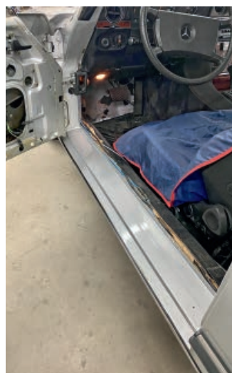
Trittschweller gereinigt und vorbereite
