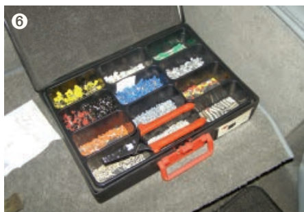
Kein Kabelanschluss ohne Adernendhülsen
