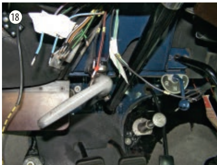
Hauptknotenpunkt des Kabelbaums für die Blinker-/Winkersteuerung
