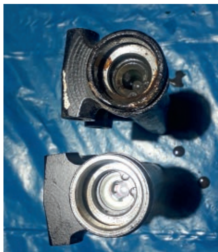
Oben: Alt mit Undichtigkeit, unten Neu Die Teilenummer des neuen Geberzylinders von DB: = A 001 295 87 06
