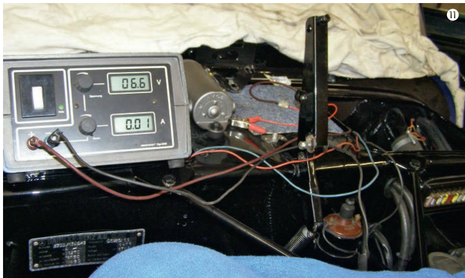
Getrennte Zuleitung: 1x für Winkerspule, 1x für Winkerlampe. Nebenbei: Montage nur mit MS-Fett
