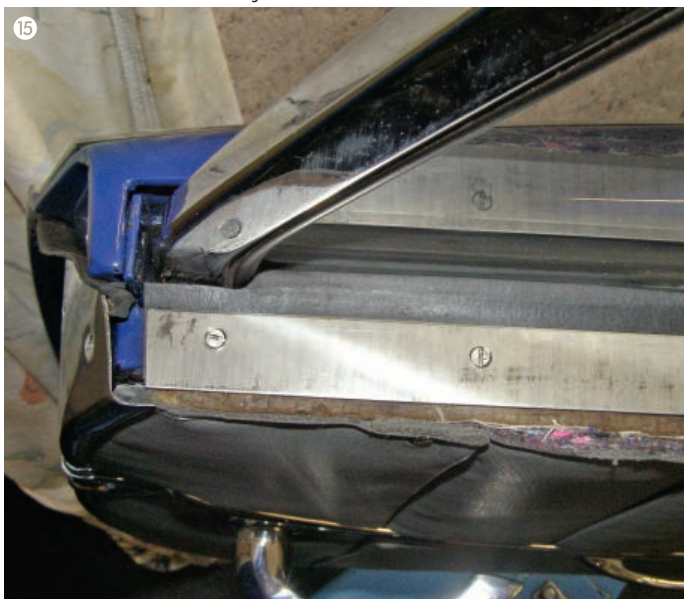
Zusätzliche innere Scheibenabdichtung montiert
