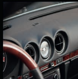
Armaturenbrettrestaurierung Vinyl in korrekter Narbung
