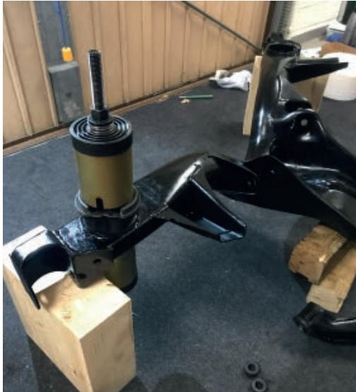
Einbau neuer Hinterachslager
