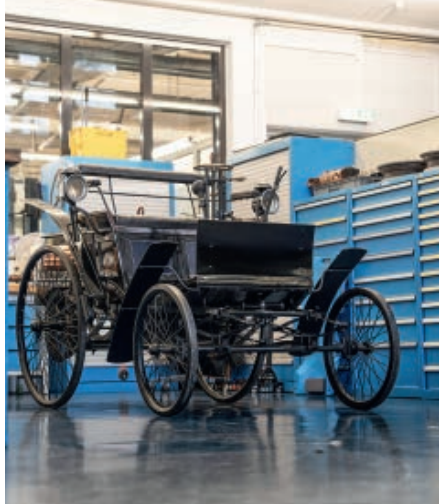
Benz Motor-Velociped mit 1,5-PS-Motor aus dem Jahr 1894. Foto aus dem Mercedes-Benz Classic Center, Fellbach, Oktober 2023.
