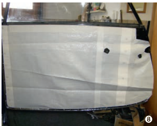
Dichtfolie zum Schutz der Türpappe montiert
