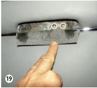
Mittige Befestigung der Türverkleidung
