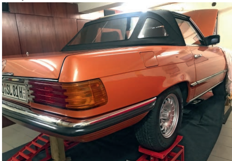
Vorbereitung zum Ausbau der Hinterachse
