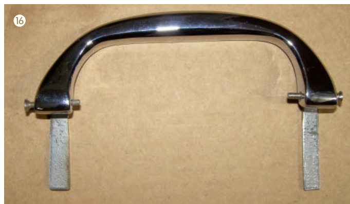
Eigenanfertigung aus ED anstatt der leicht zerbrechlichen Scharniere aus sprödem Aluguss
