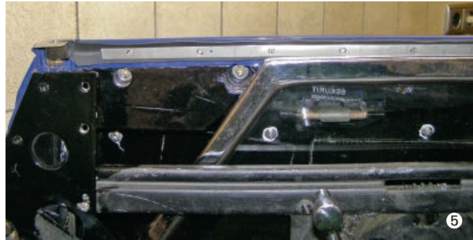
Winkelgummi mit Edelstahlstreifen befestigt
