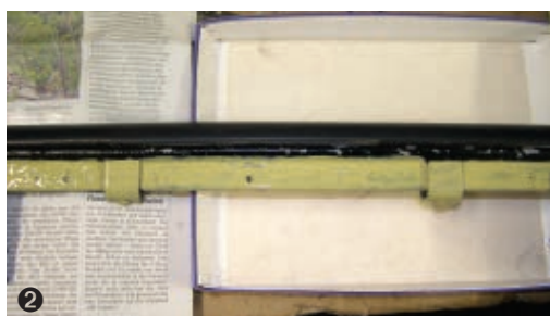
Feuerverzinkte Hebeschienen grundiert und lackiert
