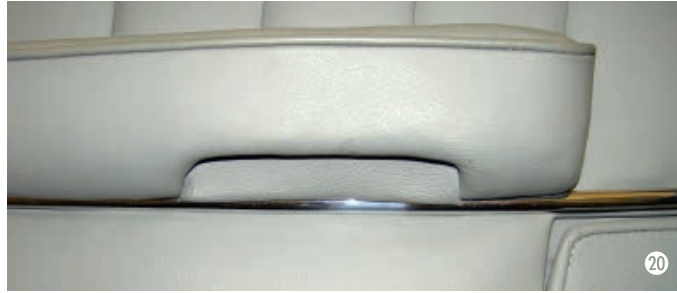
Leder darüber, Befestigung unsichtbar
