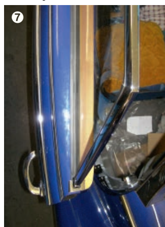
Dichtfolie zum Schutz der Türpappe montiert
