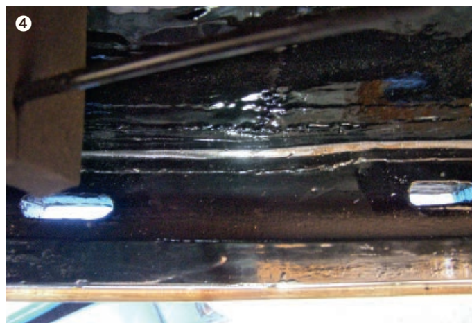
Dauerelastische Abdichtung zwischen Karosserieholz und Blechhaut
