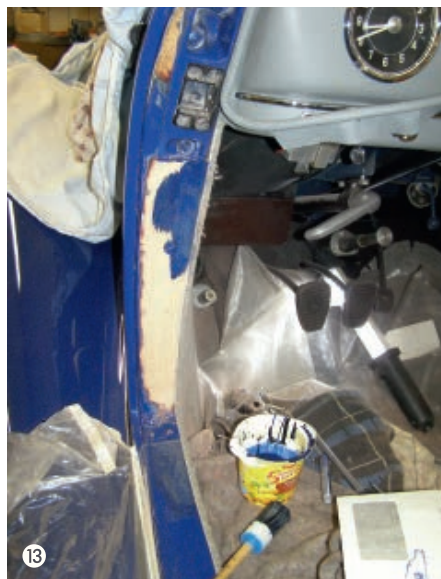
A-Säulenholz um ein paar Millimeter weggenommen
