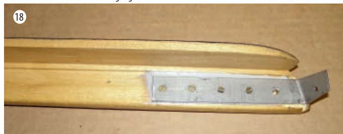
Von außen nicht sichtbare Befestigung des oberen Zierholzes
