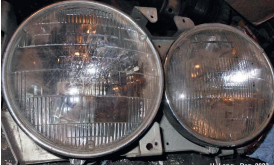
Bei Sealed Beam sind Reflektor, Lampe und Streuscheibe eine Baueinheit.
