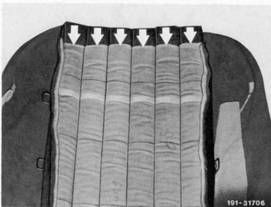
Bild 7 Befestigung der Heizstreifen in den Taschen der Gewebeunterlage
